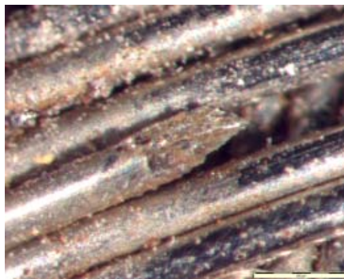
Bild 1: Bruch an Edelstahldraht
