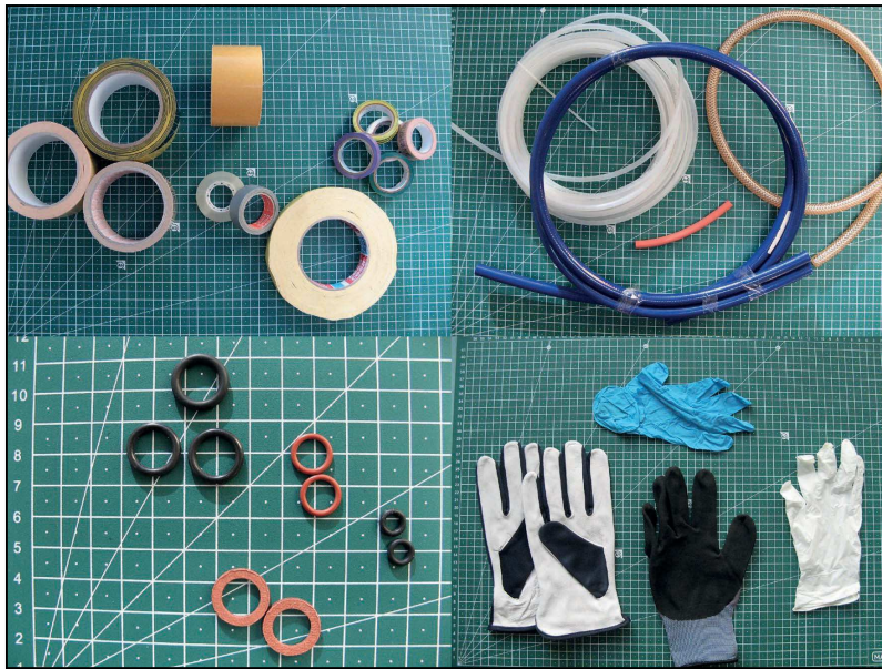
Potenzielle LABS-Quellen: Klebebänder, Schläuche, Dichtungen, Handschuhe
